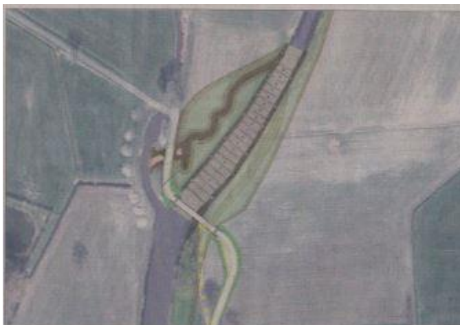
Über 20 Stufen erstreckt sich die Sohlgleite (grau) in der Dinkel. Flutmulden (hellgrüne Flächen) sollen Hochwasserschutz bieten.
